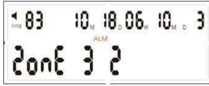
Fig.7: schermo LCD quando il sistema è allarmato
